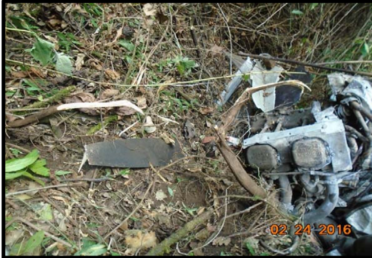
Fotografía No. 5 El motor con la hélice se separaron del fuselaje de la aeronave.
