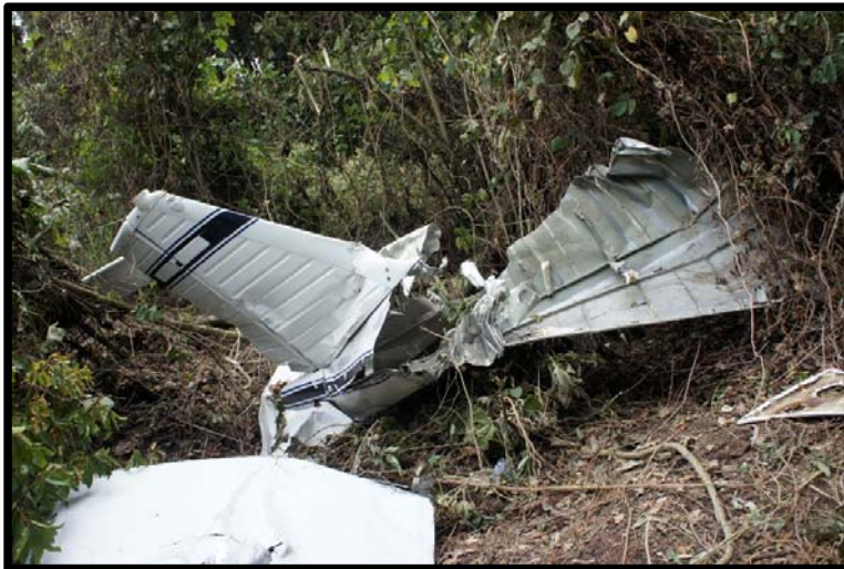
Fotografía No. 6 Forma de como quedo el Empenaje.
