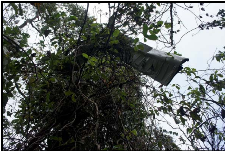
Fotografía No. 10 Una sección de los controles de vuelo (flap), sobre los árboles.
