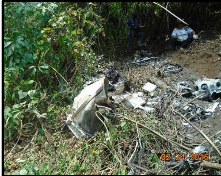
Fotografía No. 3 El fuselaje con restos de incendio.
